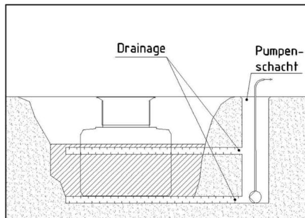
Zpravidla stačí zakrytí nádrží zeminou, aby se předešlo jejich vyplavení. Zakrytí zeminou, které je zapotřebí pro zajištění proti vztlaku, se dosáhne zpravidla tehdy, když je nádrž zakryta až k horní hraně dómu.
